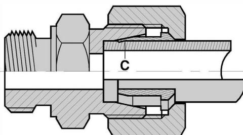
La bague coupante a pour fonction de rendre solidaire le tube du raccord. Cet assemblage sûr et solide est rendu possible grâce à la forme particulièrement étudiée de la bague.
